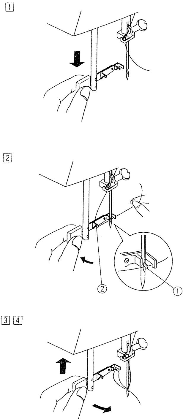
1 Поверните иглу в крайнее верхнее положение, поворачивая маховик на себя (для 5124EXP нажмите кнопку). Оттяните ручку механизма продевания нити в иголку в крайнее нижнее положение.
