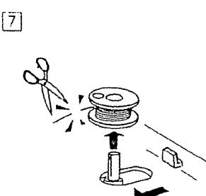
1 Поднимите держатель катушки. Установите катушку нити. После установки катушки вытяните конец нити и закрепите катушку держателем.
