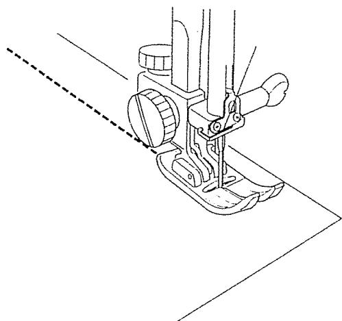
Этот прочный, долговечный стежок рекомендуется для шитья эластичных тканей или трикотажа и где нужна крепость и надежность шва. Используйте его для усиления таких деталей, как: крючки и проймы. Применяйте для придания швам сверх прочности таким вещам, как например, рюкзаки.
