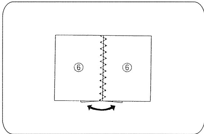
Прострочите два полотна вместе. Разутюжьте с изнаночной стороны ткань. Выбранным рисунком строчки, отстрочите с лицевой стороны шов.
