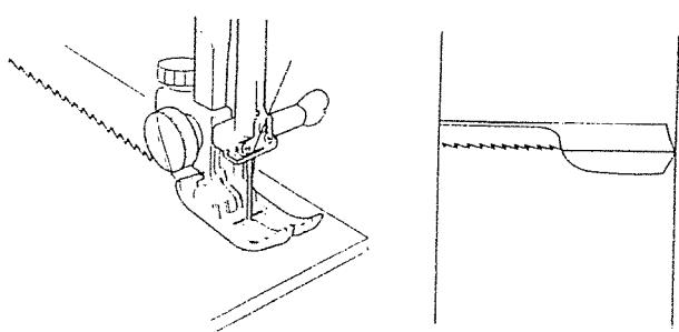
Узкий контурный трикотажный шов служит для исключения сморщивания вязаных материалов и для шитья диагональных швов. Одновременно обеспечивается ровно натянутый шов.
