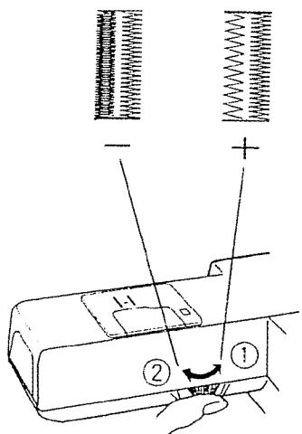
В случае, если частота стежков в петле слева и справа различна, снимите столик для принадлежностей и подрегулируйте баланс стежков.
