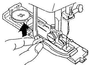
9 Когда шитье петель закончено, верните рычажок пуговничной петли в исходное состояние, нажав на рычажок петли снизу вверх до упора.
