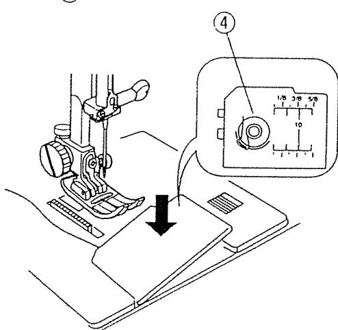
1 Расположите шпульку в держателе так, чтобы нить шла против часовой стрелки.
