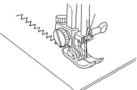
Шитье простым зигзагом широко используется для обметки, аппликации, пришивания пуговиц и т.д.
