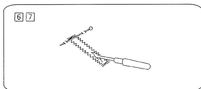
6 Отрежьте обе нити, оставив концы длиною в 10 см. Вытяните верхнюю нить на изнаночную сторону, потянув за шпулечную нить. Затем свяжите обе нити узлом.
