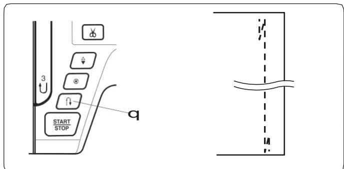
Используйте данный стежок для закрепления начала и конца шва реверсной строчкой. При достижении конца шва нажмите кнопку реверса '1' один раз. Машина сделает четыре обратных стежка, четыре стежка вперед, а затем остановится автоматически.
