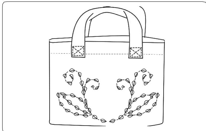
Строчки 35 и 36 в режиме 2 – это специальные строчки, которые выглядят как выполненные вручную. Используйте прозрачную нейлоновую нитку для иглы и обычную швейную нитку для шпульки. Шпульная нить вытягивается вверх на лицевую сторону ткани и стежки выглядят так, как будто они были сделаны вручную.
