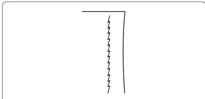
Этот узкий эластичный стежок разработан для уменьшения складок при шитье вязаных тканей и трикотажа, одновременно позволяя сделать шов плоским и полностью его раскрыть.
