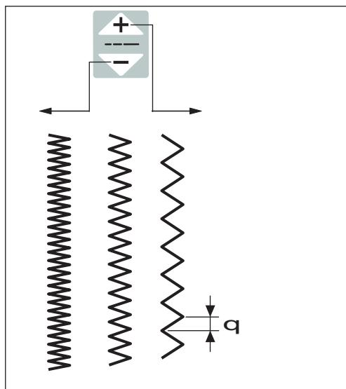
Стежок зигзаг используется при различных техниках шитья, включая сшивание через край. Его можно применять для большинства вязаных тканей.
