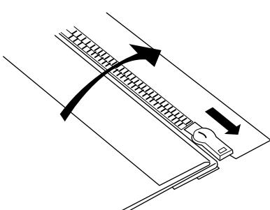
Опустите лапку на верхнюю часть ниже молнии так, чтобы игла пробивала ткань рядом со сгибом и лентой молнии.
