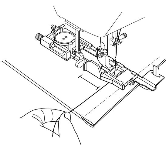
1 Вставьте выступ на стабилизационной пластине в слот на лапке для петли.
