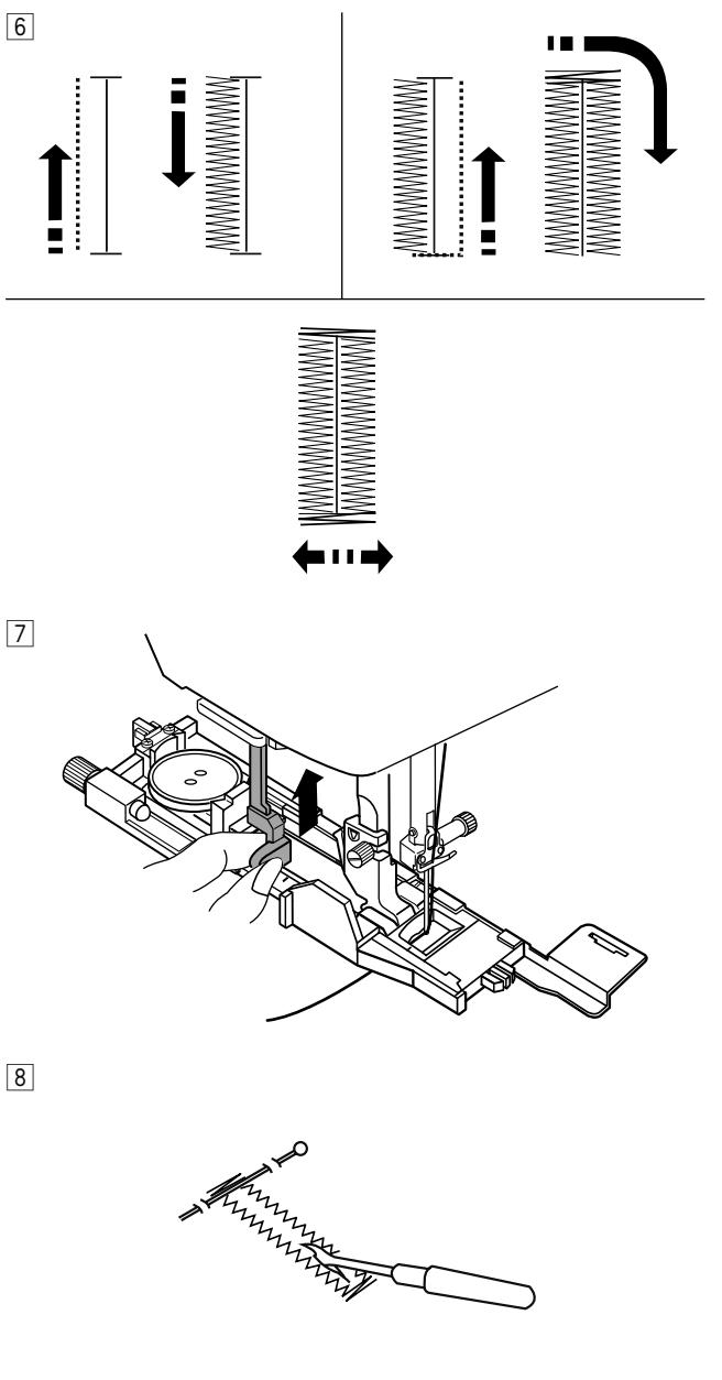
**6** Петля будет прошита автоматически в последовательности, указанной на рисунке. По завершении выполнения петли машина остановится автоматически с иглой в верхнем положении. Нажмите кнопку обрезки нити и выньте ткань.
