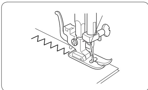
Простой зигзаг часто используется для обработки краев, пришивания пуговиц и т. д.
