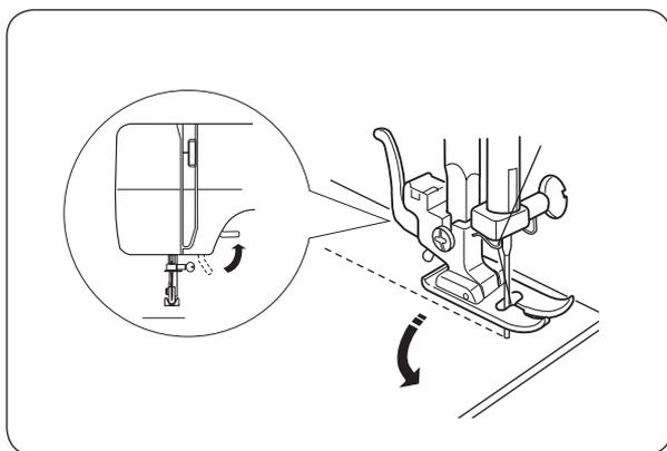
Остановите машину и опустите иглу в ткань, повернув маховое колесо против часовой стрелки.
