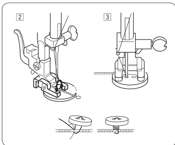
② Расположите пуговицу так, чтобы отверстия в пуговице совпадали с горизонтальной прорезью в прижимной лапке. Отрегулируйте ширину стежка таким образом, чтобы она соответствовала расстоянию между отверстиями в пуговице.
