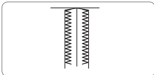
Простой зигзаг используется для отделки срезов (обметывания) большинства тканей с целью предотвращения их осыпания. Это самый быстрый способ обработки краев.
