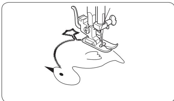
Приметайте аппликацию к ткани (или приклейте утюгом, используя отрывной стабилизатор для машинной вышивки).
