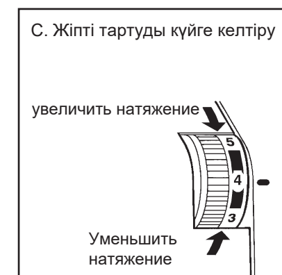
С. Жіпті тартуды күйге келтіру Бұрылып реттеуші, ұлғайтыңыз немесе жіптің керілуін жіберіңіз, азайту бойынша - аздап керілуі.
