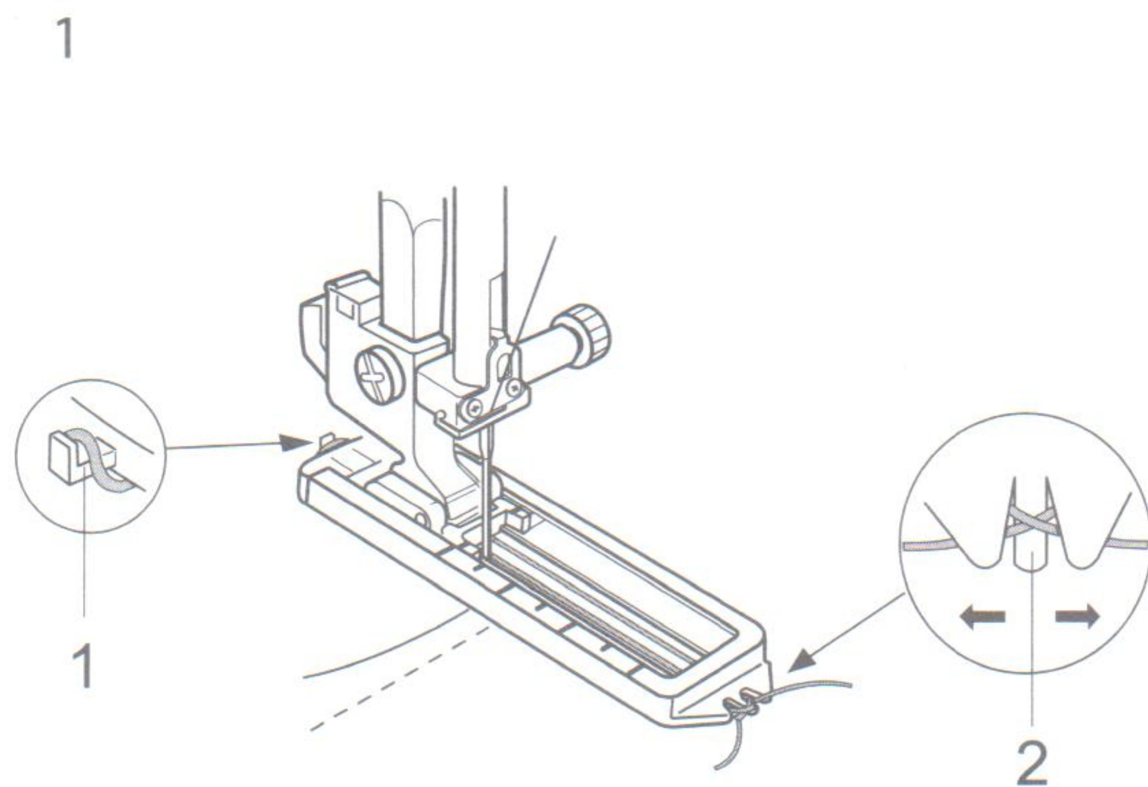
**1.** Поднимите лапку для петли, набросьте шнур на крючок сзади лапки.
