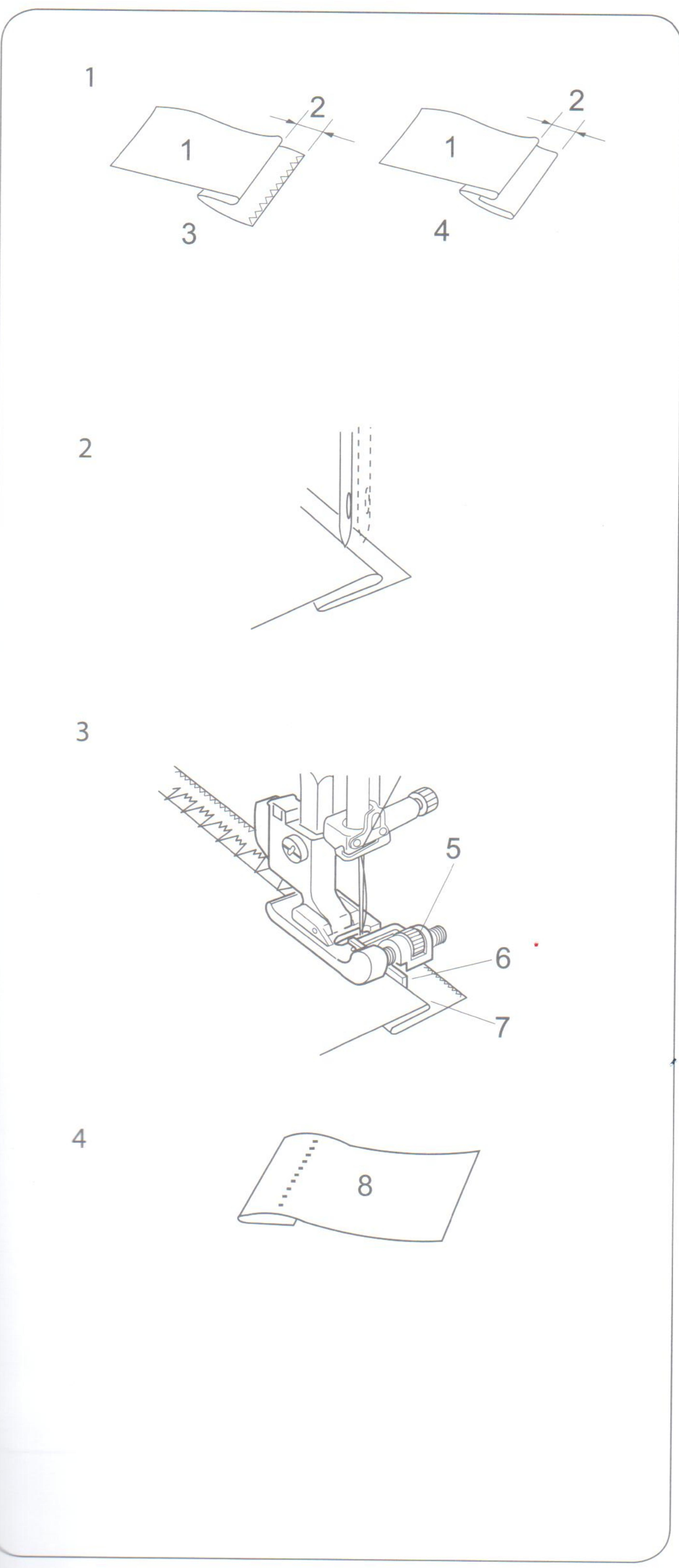
**1.** Установка лапки для потайной строчки. Идеальный потайной стежок возможен только на толстых тканях. Прикрепите лапку для потайной строчки как на рисунке. Сложите толстую ткань по схеме оставив отогнутый край от 0.4 до 0.7 см
