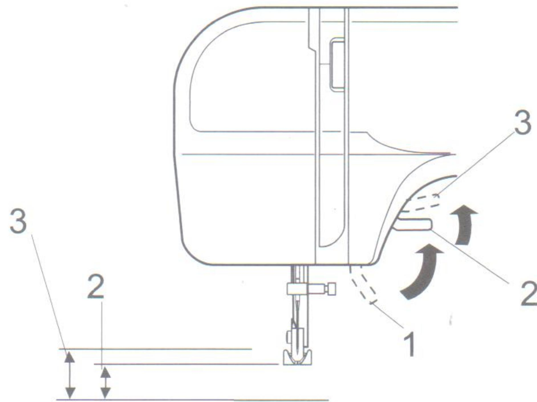
Рычаг подъема прижимной лапки поднимает и опускает прижимную лапку. Вы можете поднять лапку на 0,6 см выше обычного положения для быстрой смены прижимной лапки или для беспрепятственного размещении объемных материалов под лапкой.
